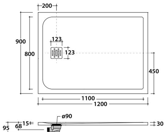
Lo scarico fornito a corredo del piatto in abbinamento alla copertura in acciaio garantisce una efficienza di scarico massima di 24 l/min.
