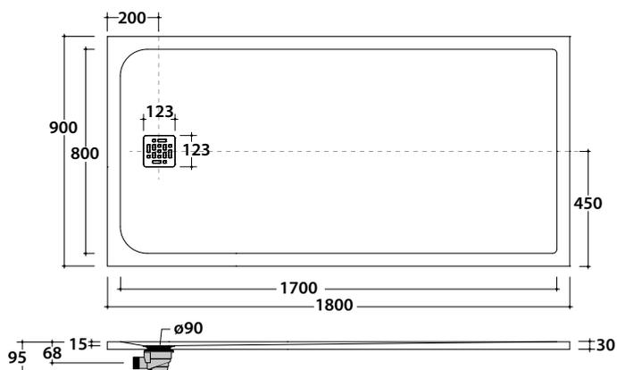
Lo scarico fornito a corredo del piatto in abbinamento alla copertura in acciaio garantisce una efficienza di scarico massima di 24 l/min.
